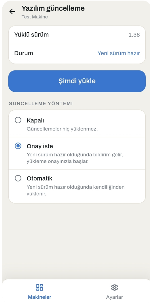
Şekil 23 · Makine ayarları → Yazılım güncelleme, “Yeni sürüm hazır” durumu ve Şimdi yükle düğmesi
