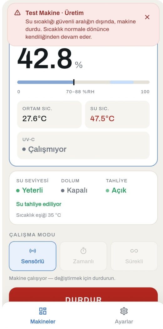
Şekil 16 · Kontrol ekranı, su sıcaklığı koruma uyarısı kırmızı bant hâlinde
